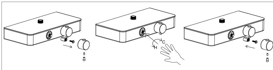
Nulstilling af termostat unit til 38°C starttemperatur
